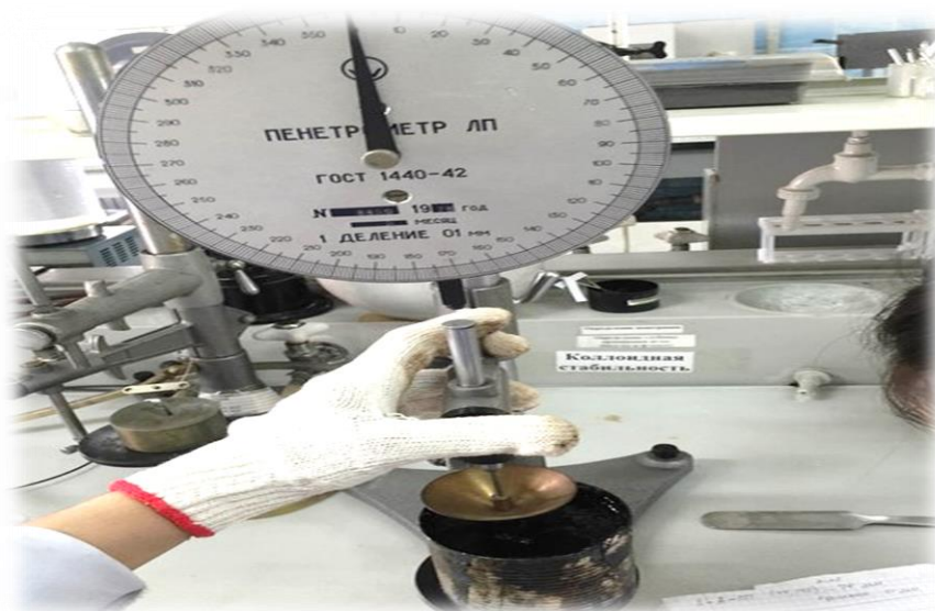
Сурет 3 – Пенетрометр аспабы арқылы иненің ену тереңдігін анықтау
